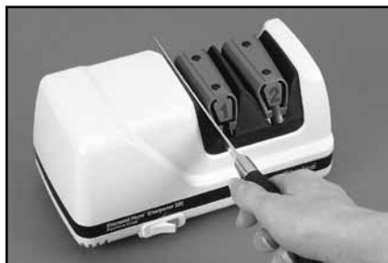
Рис. 3. Устройство 1. Вставьте лезвие в паз между направляющими и прижимной пружиной. Чередуите проходы в левом и правых пазах устройства.
