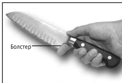
Рис. 16. Если лезвие вашего ножа имеет незаточенную часть значительной длины у основания вблизи рукоятки, возможно, вам будет удобно поместить указательный палец на этой незаточенной части при заточке.
